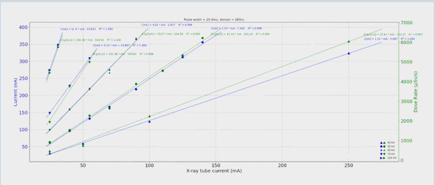
A dependência linear entre a corrente medida no sensor e a taxa de dose fornecida pelo dispositivo de referência é observada, conforme esperado e apresentado na figura abaixo:
